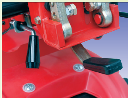
Schnellverstellung der Handholmen réglage rapide du mancheron
