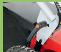
massive Holmenver- stellung réglage du mancheron
