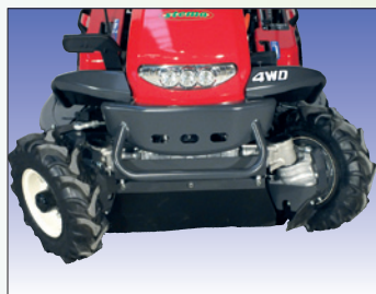
großer Lenkeinschlag trotz Allrad grande angle de braquage malgré traction 4 roues motrices
